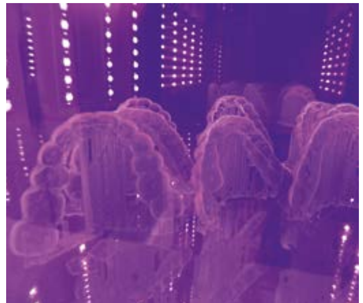
Links: Unscheinbar, aber wirkungsvoll: eine 3-D gedruckte Michigan-Schiene, die schon virtuell eine Front-Eckzahnführung über eine digitale Axiographie eingebaut hat. Rechts: 3-D Druckmaterialien bedürfen einer entsprechenden fachgerechten Bearbeitung. Hier Schienen im Lichtofen zur Materialaushärtung.
